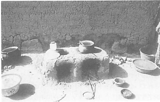
図4. 改良カマド、土と牛糞を混ぜて固めて作る。薪の消費が減るので喜ばれている。
