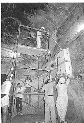
写真4. 電磁波探査レーダーで、壁面を傷つけることなくピラミッド内の未知の空間を探す。
