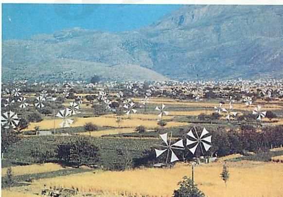
写真6. クレタ島ラシチ盆地のセイルウィング型揚水風車群. (1983年9月)
